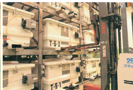
脚(差し込みタイプ)によりフォークリフトでの移動を簡素化し、省スペース化を実現しました
