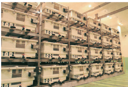
脚(差し込みタイプ)によりフォークリフトでの移動を簡素化し、省スペース化を実現しました
